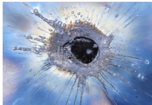
شکل ۱۲- اثر واکنش ترمیتی حاوی اکسید آهن میکرونیزه.
