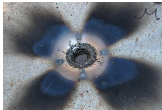
شکل ۱۱- اثر واکنش ترمیتی حاوی اکسید آهن میکرونیزه.
