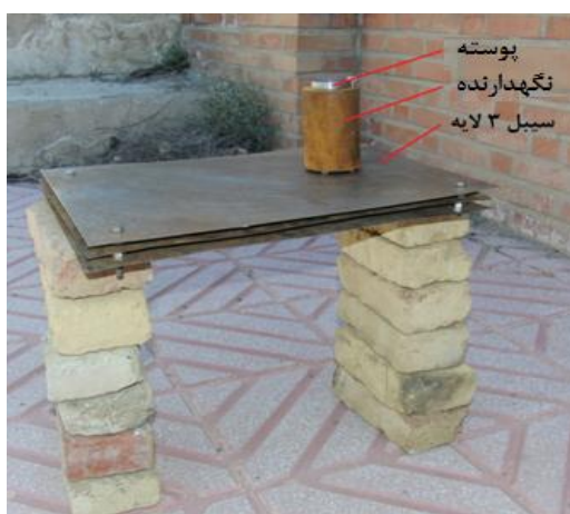
شکل ۲- چیدمان آزمون عملکردی اشتعال مخلوط ترمیتی.
