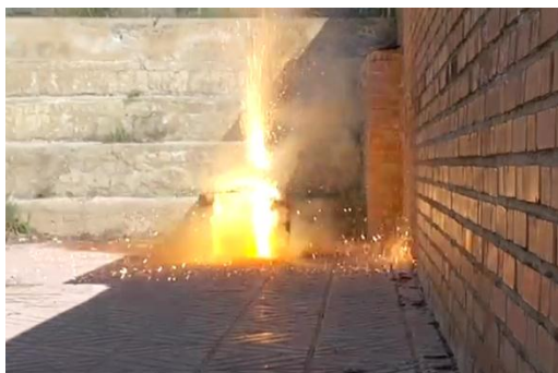
شکل ۹- واکنش مخلوط ترمیتی حاوی اکسید آهن میکرونیزه.
