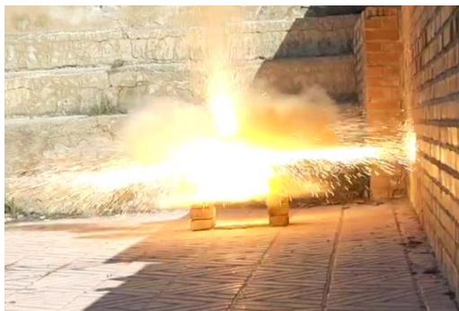
شکل ۱۰- واکنش مخلوط ترمیتی حاوی اکسید آهن نانو.
