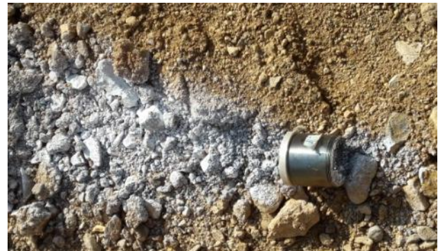
شکل ۱۰- نمونه PBXIR-103 پس از انجام آزمون حساسیت به چاشنی.
