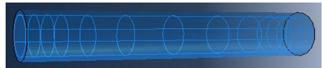
شکل ۲- مدل اجزای محدود میلگردهای طولی و عرضی ستون دایره‌ای.
