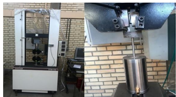
شکل ۶- آزمون فشار بر روی نمونه‌های مواد دانه‌ای.
