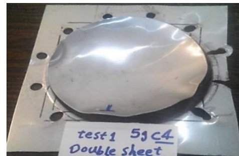
شکل ۱۳- نتایج تجربی آزمون انفجار نمونه‌های بدون هسته برای ۵ گرم خرج انفجاری C4.
