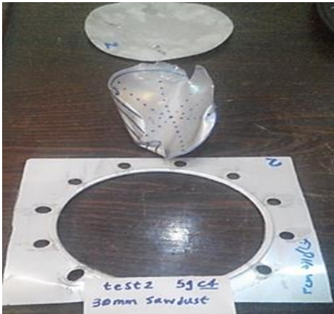
شکل ۱۵- نتایج تجربی نمونه با هسته خاکاره به ضخامت ۳۰ میلی‌متر و خرج ۵ گرم ماده منفجره C4.
