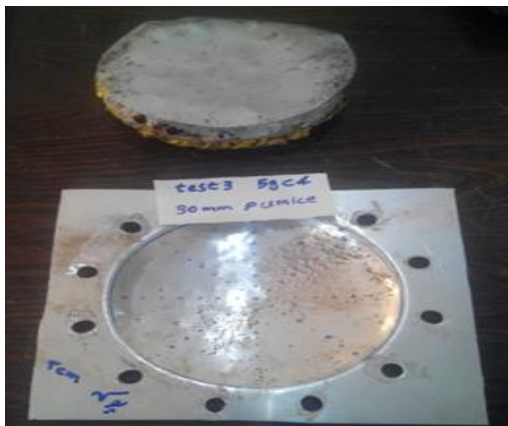
شکل ۱۷- نتایج تجربی نمونه با هسته پوکه معدنی به ضخامت ۳۰ میلی‌متر و خرج ۵ گرم C4.
