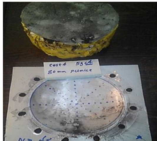
شکل ۱۹- نتایج تجربی نمونه با هسته پوکه معدنی به ضخامت ۸۰ میلی‌متر و خرج ۵ گرم ماده منفجره C4.
