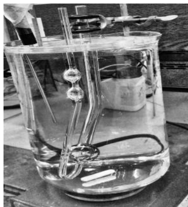
شکل ۴- تصویر چیدمان آزمون تعیین گرانروی سینماتیک (چپ) و شماتیک ویسکومتر استوالد (راست).
