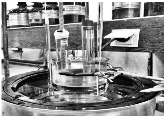
شکل ۳- تصویر آزمون نقطه نرم‌شوندگی.
