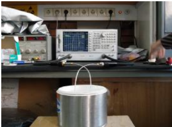
شکل (9): سسیتم اندازه گیری مشخصات فیلتر ابررسانا
