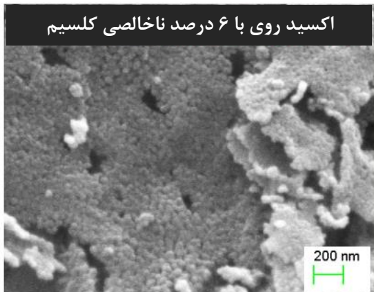
شکل (۳): تصویر SEM نانو ساختارهای اکسید روی آلاییده با الف) ۲٪ و ب) ۶٪ کلسیم
