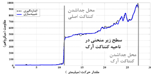
شکل (۶): نتیجه اندازه‌گیری مقاومت دینامیکی برای کلید ۲۴ کیلو ولت گازی SF 6 در حالت واقعی و شبیه‌سازی
