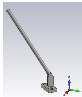
شکل (۸): یک المان پیشنهادی از آنتن مونوپل زاویه دار در باند فرکانسی UHF
