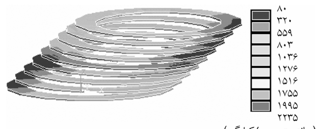
شکل ۸- توزیع تنش ون میسر پس از پایان بارگذاری قائم و برشی برای جداساز در حالت \frac{b}{r_s} = 0.25 .
