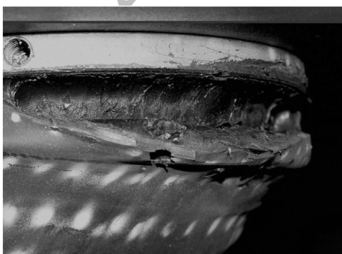
شکل ۱۴- تصویر بریده شدن لاستیک در ناحیه نزدیک به صفحه بالایی جداساز ۲ در انتهای بارگذاری شماره ۸.
