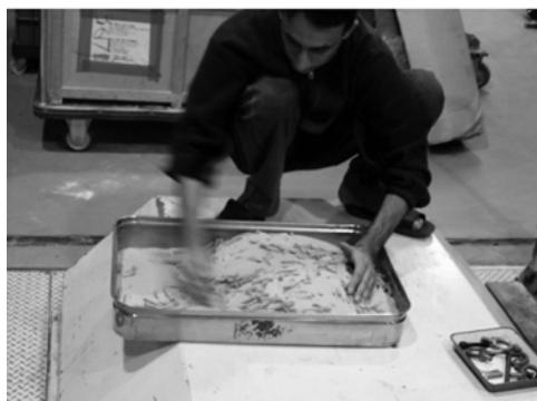
شکل ۴. آماده‌سازی مصالح ماسه‌ای مسلح شده با الیاف ژئوتکستایل.
