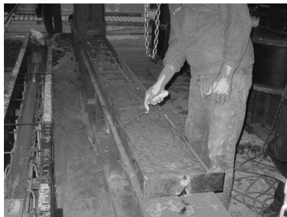
شکل ۲. شناژ تحتانی متصل شده به قاب.
