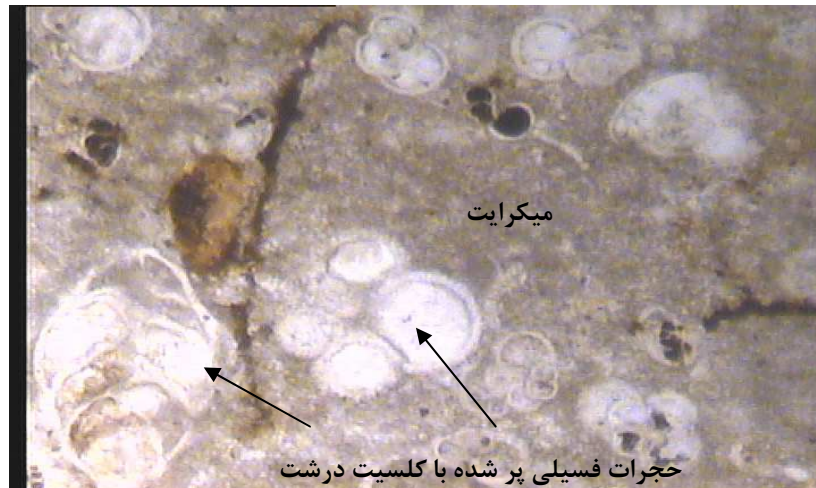
شکل ۱: حجرات و فسیل‌های فرامنیفر کلسیتی و قطعات فسفات‌ه درگیر با مواد آلی و اکسیدهای آهن در زمینه میکرایتی. نور معمولی (بدون پلاریزور و آنالیزور). بزرگنمایی ۲۰×
