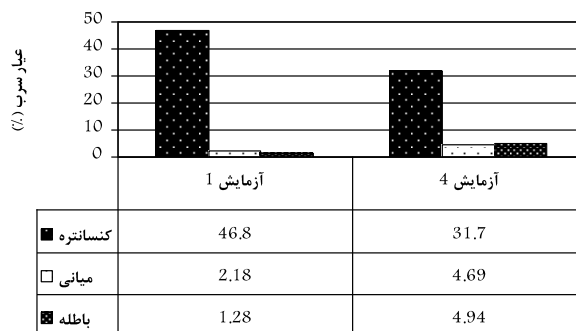
شکل 82: تاثیر کاهش شیب و افزایش آب شستشو و خوراک بر عیار (دانه ریز)
