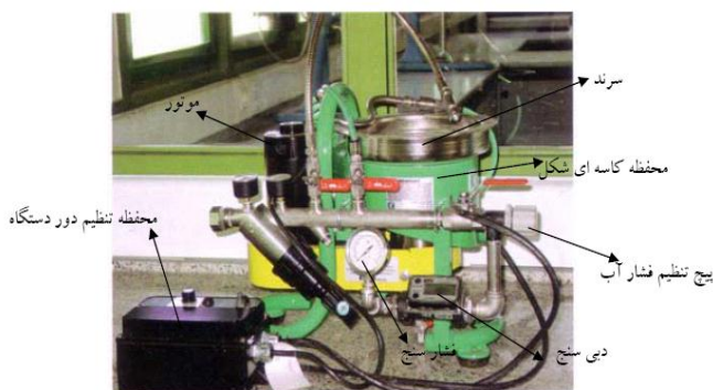
شکل 3: تصویر دستگاه نلسون 3 اینچی مورد استفاده در آزمایش‌ها
