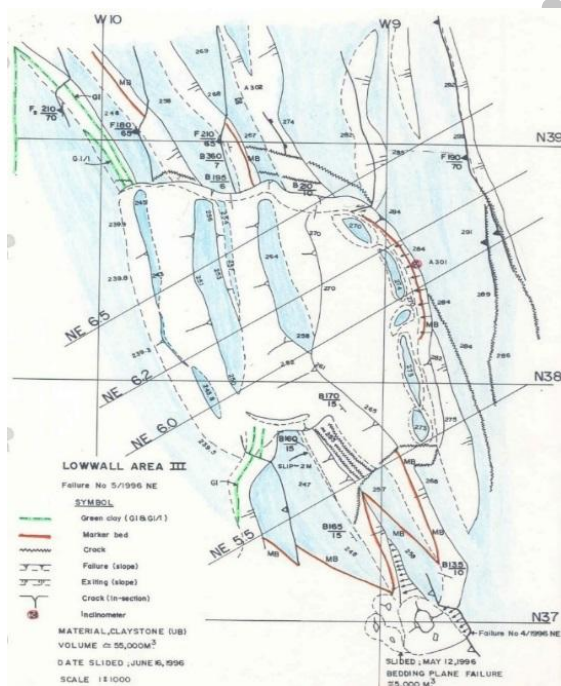
شکل ۱۱: نقشه لغزش در بخشی از دیواره شمال شرقی در سال ۱۹۹۶ میلادی [۱۲]
