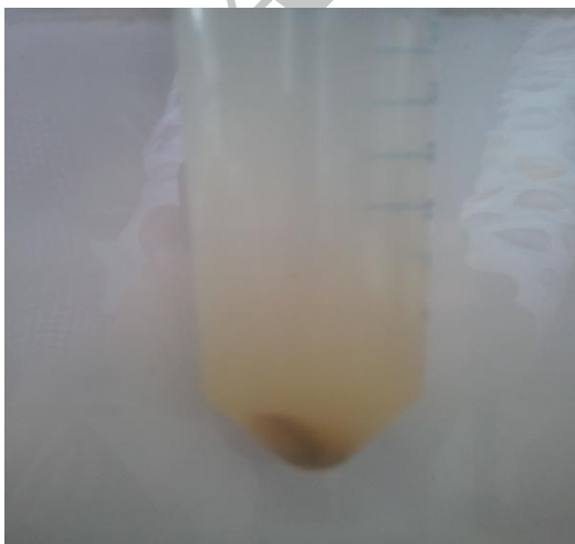
شکل ۴: تخریب نانوجاذب بنتونیت-چیتوسان در \text{pH} \leq 3 [۱۲]
