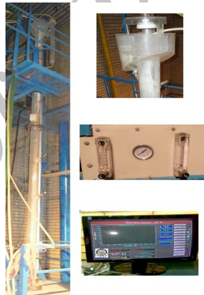
شکل ۲: ستون فلوتاسیون نیمه صنعتی
