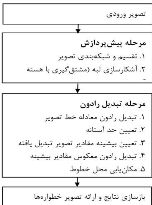
شکل ۳: فلوجارت روش ارائه شده جهت تشخیص خطواره‌های تصویر براساس تبدیل رادون.
