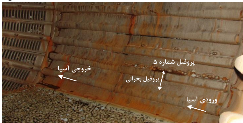
شکل ۶: موقعیت پروفیل بحرانی روی آسترهای جداره آسیای نیمه‌خودشکن سرچشمه
