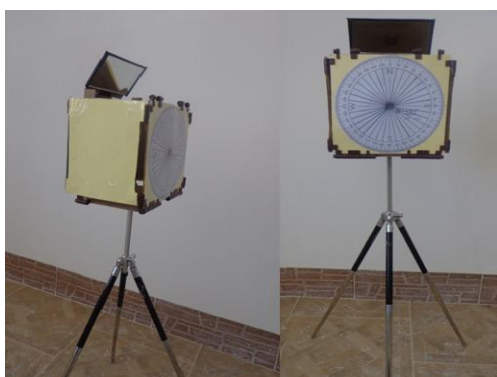
شکل ۶: دستگاه برداشت کننده‌ی مقطع تونل به روش قطبی
