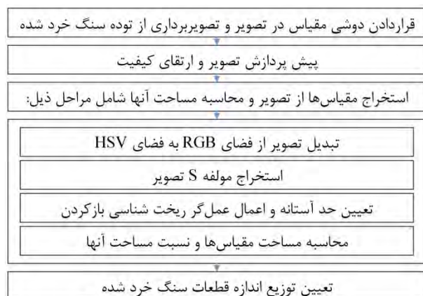
شکل ۴- مراحل پیش‌پردازش و رفع خطای اعوجاج تصویر دیجیتال قطعات سنگ خرد شده
