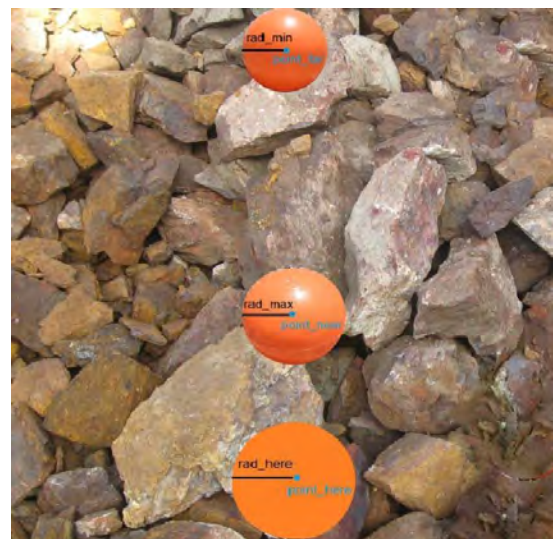
شکل ۱۲- پارامترهای تبدیل هندسی رفع خطای اعوجاج بر روی یک نمونه تصویر توده سنگ خرد شده
