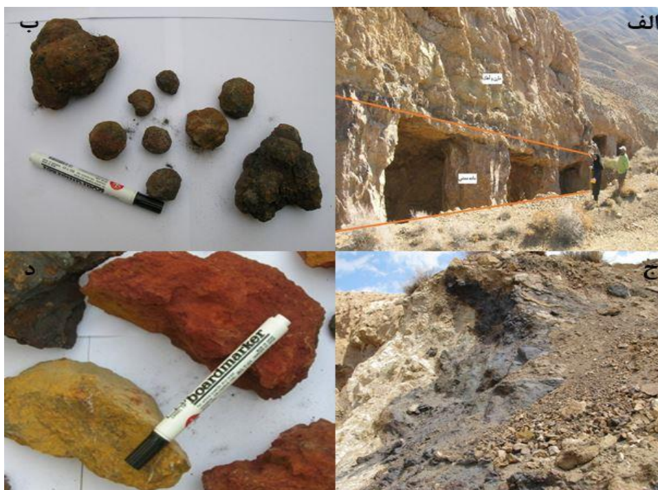
شکل ۲- الف) کانسنگ سخت هماتیت - مگنتیت که به فرم لایه‌ای و هم شیب با واحد رسوبی آهک ماسه‌ای قرار گرفته است. در شکل استخراج اتاق - پایه معدنی نیز مشاهده می‌شود، ب) گرهک‌های هماتیته منفرد و تجمعی، ج) افق سیاه رنگ مربوط به هماتیت‌های نرم میزبان گرهک‌ها که با کنتاکت موجدار به آهک‌های ماسه‌ای اتصال دارد، د) کانسنگ هماتیت اخری و لیمونیت
