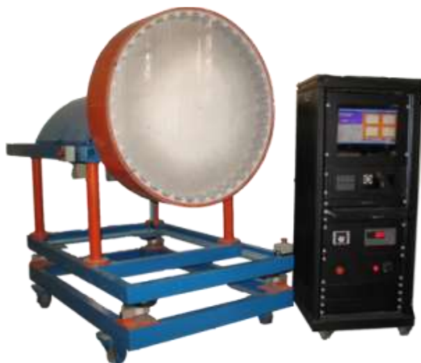
شکل ۳- آسیای آزمایشگاهی مرکز تحقیقات فرآوری مواد کاشی‌گر
