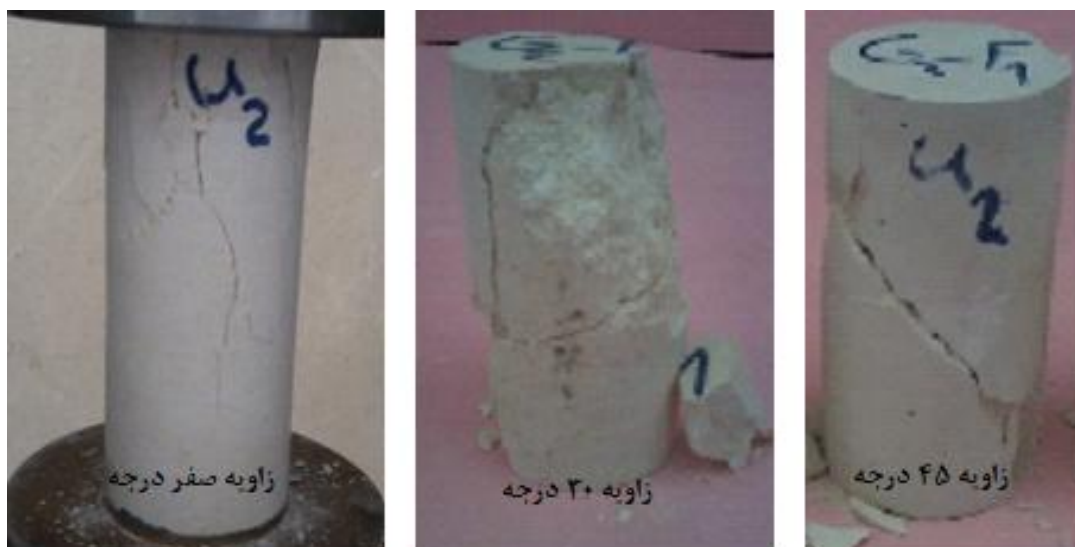
شکل ۱۲- شکست در بدنه سالم نمونه‌های دارای ناپیوستگی زبر موج‌دار دارای زاویه شیب صفر و ۳۰ درجه و لغزش در امتداد ناپیوستگی زبر موج‌دار دارای زاویه ۴۵ درجه تحت تنش یک محوری
