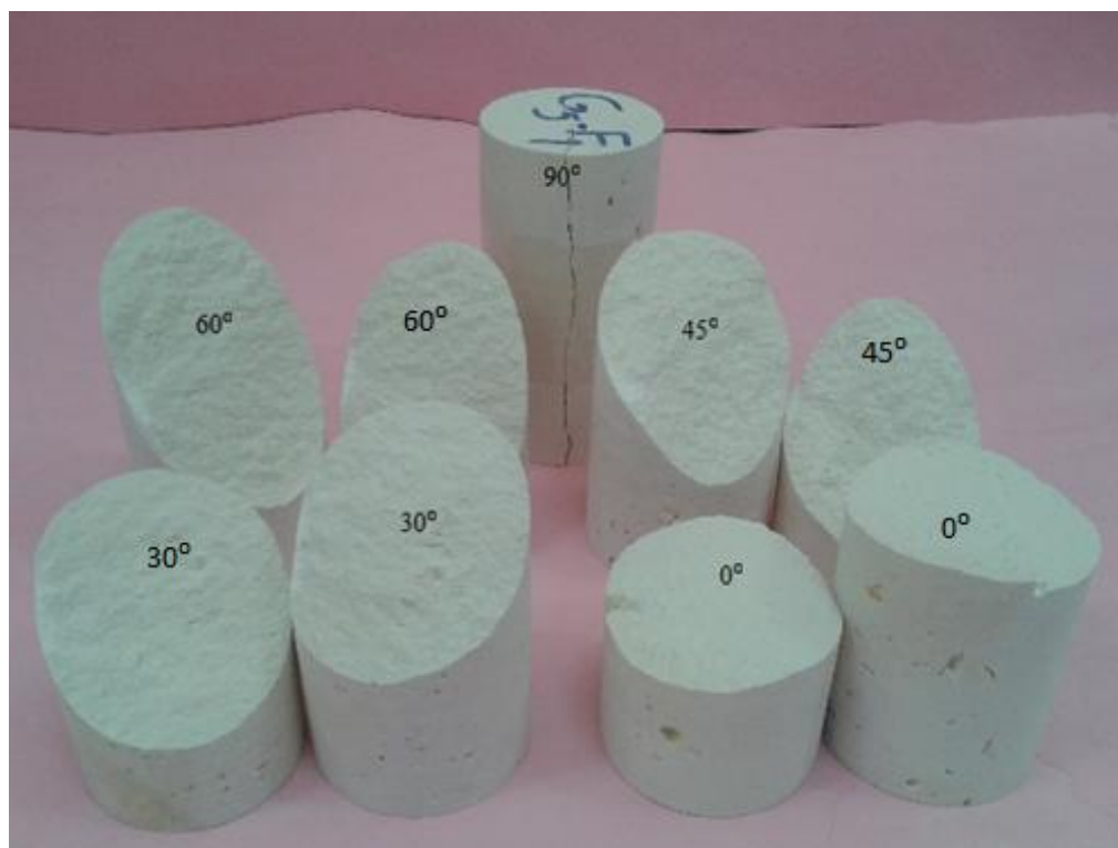
شکل ۳- نمونه‌ای از هریک از گروه‌های ناپیوستگی زبر موجدار (R-L) دارای شیب‌های ۰، ۳۰، ۴۵، ۶۰ و ۹۰ درجه
