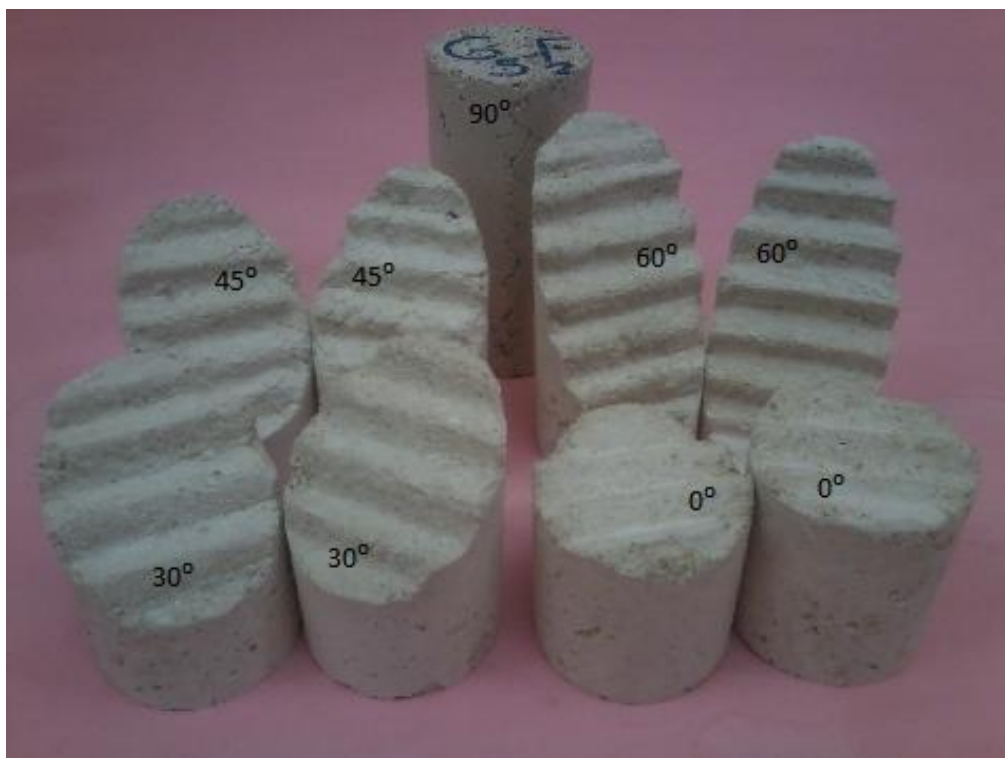
شکل ۲- نمونه‌ای از هریک از ناپیوستگی دنداندار (T-M) دارای شیب‌های ۰، ۳۰، ۴۵، ۶۰ و ۹۰ درجه پس از آماده‌سازی با استفاده ماده مدل
