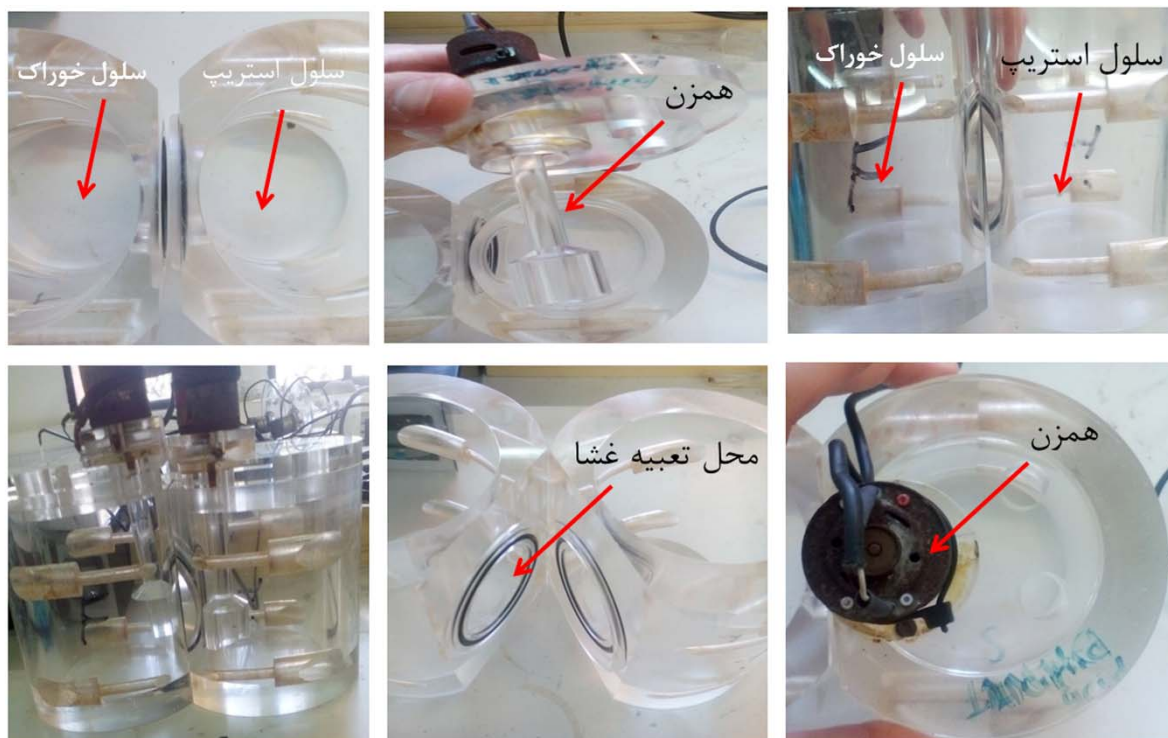
شکل ۱- نماهای مختلفی از تجهیز مورد استفاده در سیستم غشای حلال آلی صفحه‌ای.
