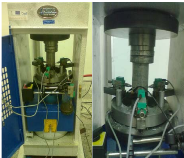
شکل ۵- اندازه‌گیری پارامترهای مربوط به مدل‌سازی آزمون فشاری تک‌محوره در آزمایشگاه
