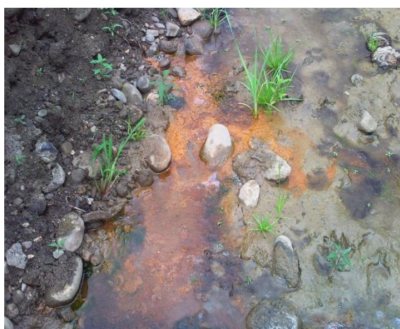
شکل ۳- شواهدی مبنی بر اکسایش پیریت و تولید زهاب در پایین دست باطله‌های حاصل از فرآیند شستشوی زغال در کارخانه زغال‌شویی انجیر تنگه.
