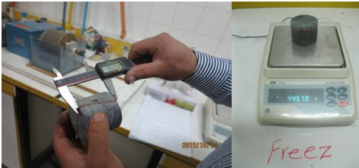
شکل ۹- اندازه‌گیری حجم و چگالی خشک نمونه‌ها.
