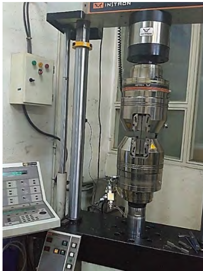
شکل ۴- آزمون‌های کشش با استفاده از دستگاه Instron8502
