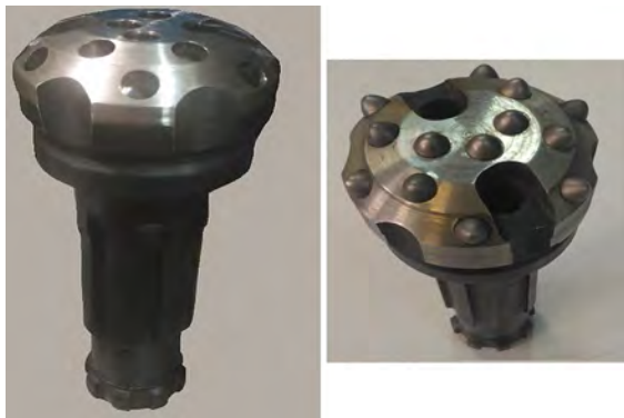
شکل ۱۰- سرمته ساخته شده: سمت چپ، قبل و سمت راست، بعد از اتصال اینسرت‌ها
