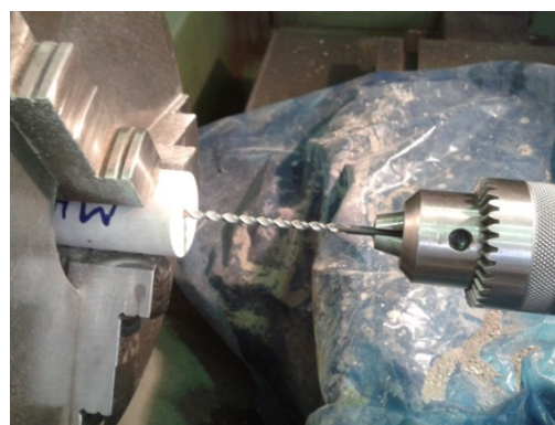
شکل ۲- ایجاد و حفر گمانه
