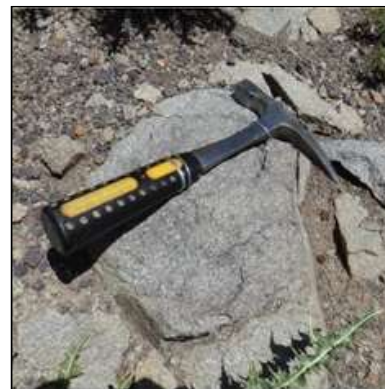
شکل ۵- رخنمونی از توده سنگ آذرین EAT2 (آندزیت) دربرگیرنده تونل کرمان: الف- سطح زمین؛ ب- جبهه کار تونل در ۳+۵۵۰ کیلومتر [۱۹].
