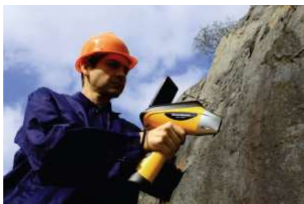
شکل ۸- انجام آزمایش حین کار در جبهه‌کار.
