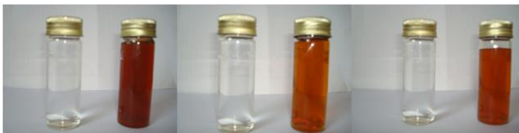
شکل شماره ۱. تغییرات رنگ در تشکیل نانوذرات نقره. مایع بی رنگ نیترا نقره، نانوذرات نقره سنتز شده از (آ) مان بلوط، (ب) صمغ گیلاس، (پ) صمغ زردآلو.
