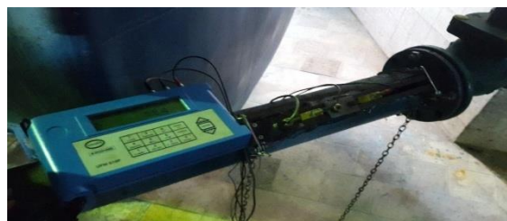
شکل ۲- سامانه اندازه‌گیری دی‌آب ورودی و خروجی هر تجهیز
