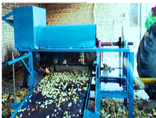
شکل ۲- شماتیک دستگاه ساخته شده جداساز دانه آفتاب‌گردان آجیلی، واحد کوبنده: ۱- کانال ورودی، ۲- تغذیه‌کننده، ۳- ضربه‌زن، ۴- شبکه جداساز، ۵- شفت کوبنده، ۶- پوشش استوانه کوبنده، ۷- مجموعه الک‌ها، ۸- محور نوسان‌کننده و ۹- انتقال‌دهنده توان
