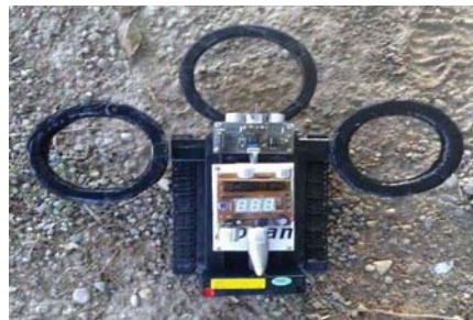
شکل ۶- افزایش تعداد سنسورها بر روی ربات و نحوه قرار گرفتن آنها
