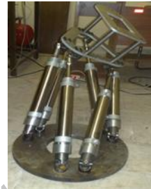
شکل ۱- روبات موازی دانشگاه خواجه نصیرالدین طوسی برای توانبخشی اندام های پایین
