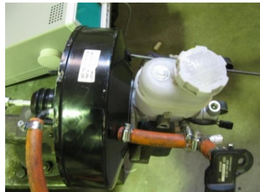
شکل ۱۸: بوستر ترمز مجهز به ادوات اندازه گیری
