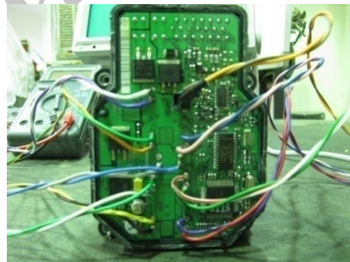
شکل ۱۷: بلوک سیستم ترمز ضد قفل مجهز به سیم های دریافت سیگنال
