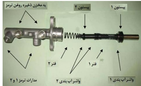
شکل ۷: اجزا داخلی سیلندر اصلی [6]
