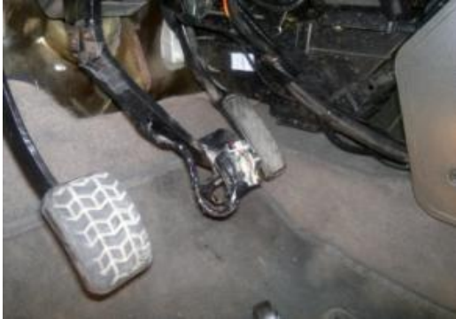
شکل ۱۹: نیروسنج نصب شده بر روی پدال ترمز
