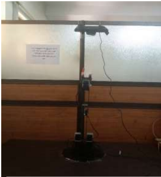
شکل ۹: نحوه قرارگیری کینکت نسبت به ربات جدول ۱: مشخصات موتورهای ربات
