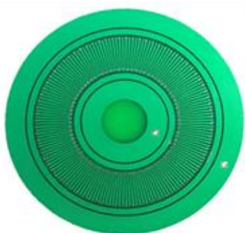
شکل ۳: شکل شماتیک انکودر خازنی دورانی طراحی شده
