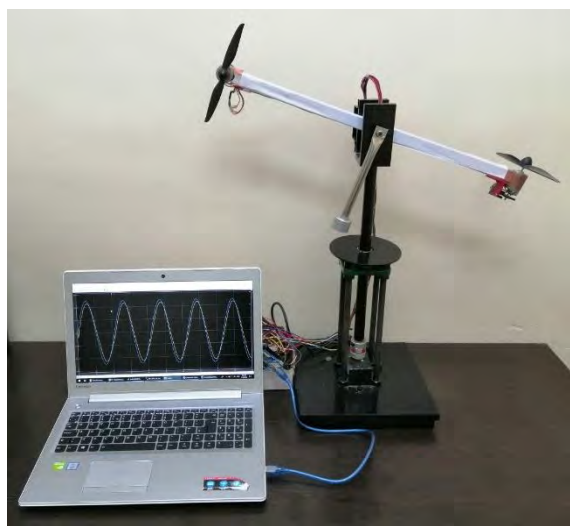
شکل ۲: ساخت سیستم واقعی TRMS در محیط آزمایشگاهی
