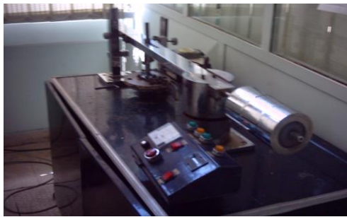
ب) دستگاه آزمون پین روی دیسک
