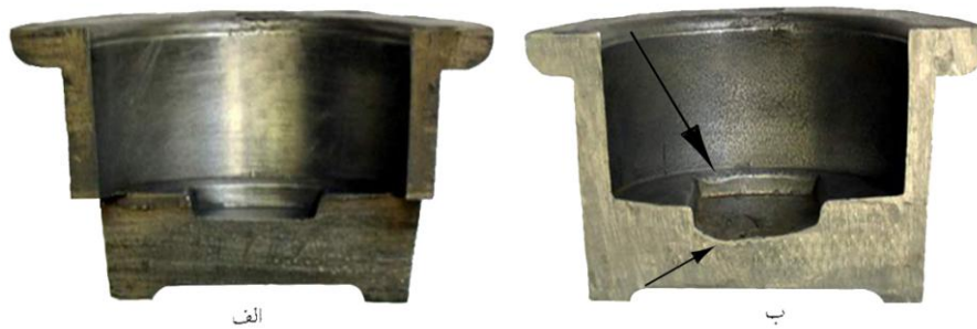
شکل ۳. مقایسه کیفی پیستون‌های تولیدی در دو حالت: الف کوبشی، ب ثقلی از نظر وجود عیب فرورفتگی سطحی.
