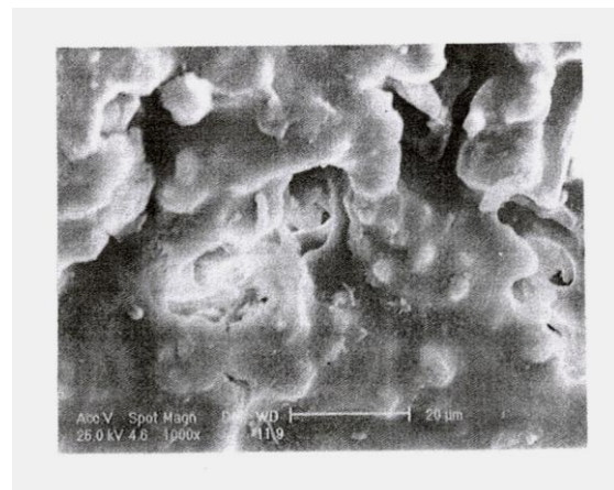
شکل ۲- تصویر میکروسکوپی SEM از سطح لایه نازک سیلیکا (پخت نشده N_2 )
