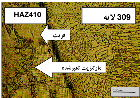
شکل ۶. تصویر میکروسکوپ نوری زیر لایه ۴۱۰ و پوشش ۳۰۹
