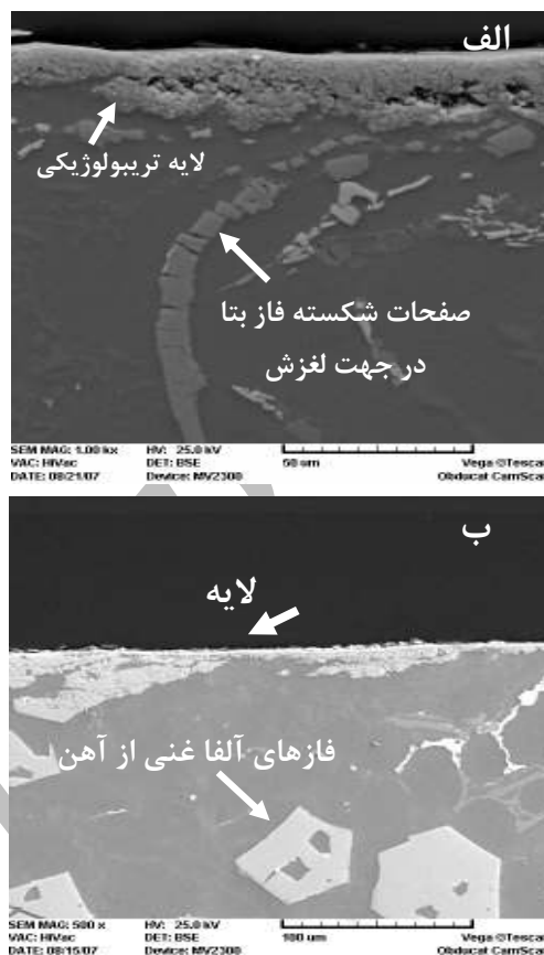
شکل ۷. تصاویر میکروسکپ الکترونی (SEM) از نواحی زیر سطح سایش دو آلیاژ 1/8\text{Fe} و 1/8\text{FeMn} پس از سایش تحت بار 40\text{N} در دو شرایط (الف) بهسازی نشده و (ب) بهسازی شده توسط منگنز.
