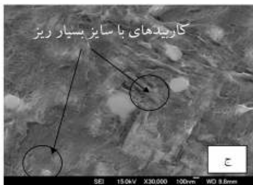
شکل ۹. ساختار میکروسکوپی الکترونی (الف، ب، پ) نمونه کوئنچ- تمپر در بزرگنمایی های مختلف (ت، ث، ج) نمونه کوئنچ- زیرصفر عمیق - تمپر در بزرگنمایی های مختلف.
