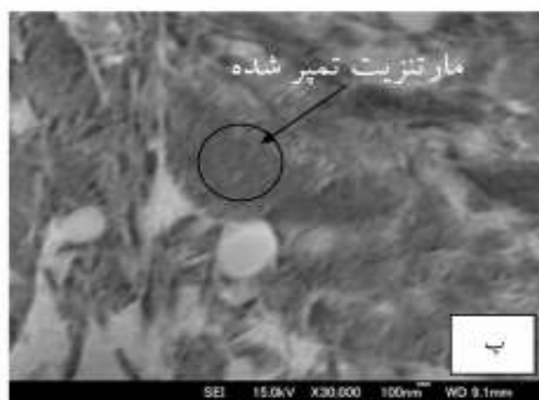
شکل ۹. ساختار میکروسکوپی الکترونی (الف، ب، پ) نمونه کوئنچ- تمپر در بزرگنمایی های مختلف (ت، ث، ج) نمونه کوئنچ- زیرصفر عمیق - تمپر در بزرگنمایی های مختلف.
