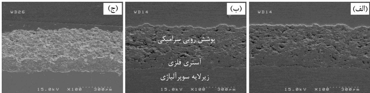
شکل ۴. تصاویر میکروسکوپی الکترونی روبشی گسیل میدانی از سطح مقطع پولیش شده سیستم سد حرارتی؛ (الف) YSZ متداول، (ب) CYSZ متداول و (ج) YSZ نانوساختار.
