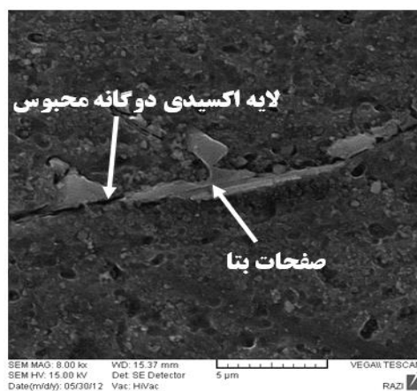
شکل ۷. چگونگی جوانه زنی و اشاعه ترک از فصل مشترک فاز بتا با زمینه در آلیاژ \text{Al-5Si-1.2Fe} .
